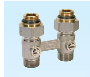
H-kappale sululla, suora. Mm. Modul Compact Integraa varten, k/k 50 mm M22. 2-putkijärjes- telmä, 1-putkijärjestelmä.
