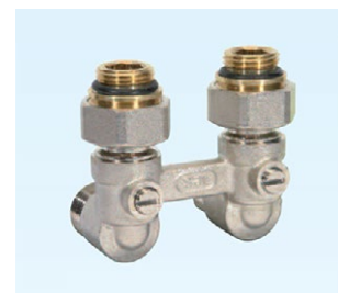
H-kappale sululla, kulma. Mm. Modul Compact Integraa varten, k/k 50 mm M22. 2-putkijärjes- telmä, 1-putkijärjestelmä.
